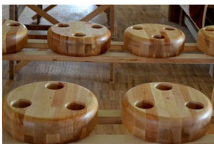
設計通りの精密3次元加工ーフロッカーの木製ストーン
